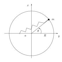
Ein Massenpunkt m bewege sich auf einer vorgeschriebenen Kreisbahn mit Radius R. Er sei durch eine Feder einer exzentrisch wirkenden Kraft ausgesetzt. Die Federkonstante sei k, die Ausdehnung der entspannten Feder im Verhältnis zu (R-a) vernachlässigbar (siehe Skizze). Die Länge der Feder sei mit  $\ell$  bezeichnet. Im entspannten Zustand ist  $\ell=R$ . Verwenden Sie im Folgenden Polarkoordinaten.
