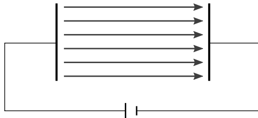
Abbildung 1: Ein Plattenkondensator mit elektrischen Feldlinien
