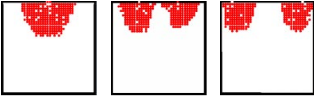
Abbildung 3.17: Typische Staukonfigurationen vor einem Raum mit zwei Türen und (a) keinem Abstand zwischen den Türen, (b) mittlerem Türabstand, und (c) den zwei Türen in der Nähe der zwei Ecken des Raumes.
