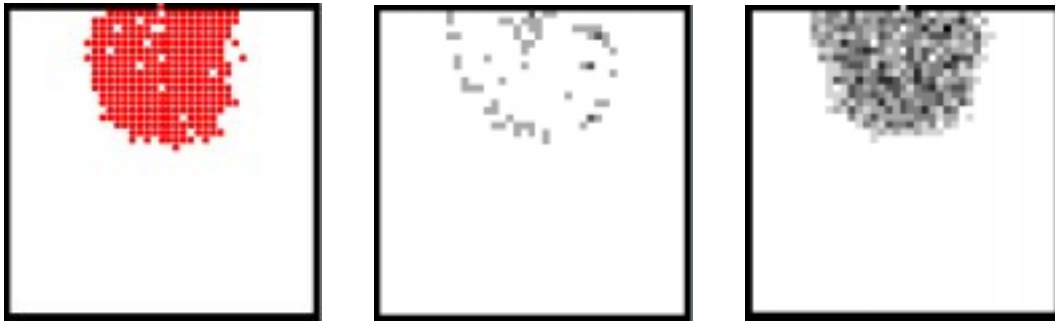
Abbildung 3.16: Graphische Darstellung einer Simulation und der zugehörigen dynamischen Felder D und \tilde{D} (für \alpha = 0 , \delta = 0.3 ): (a) typischer Zustand der Dynamik während einer Evakuierung und (b) das dynamische Feld D proportional zur Geschwindigkeitsdichte der Teilchen; (c) Dynamisches Feld \tilde{D} für das modifizierte Modell mit \tilde{D} proportional zur Teilchendichte.
