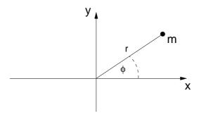
Die Lagrange-Funktion für die zweidimensionale Bewegung eines Massenpunkts in einem Zentralpotential V(r)  $(r=|\vec{r}|)$  mit den generalisierten Koordinaten r und  $\phi$  (siehe Abbildung) lautet
