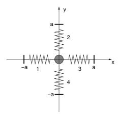
Betrachten Sie das in der Abbildung dargestellte zweidimensionale System aus einem Teilchen der Masse m und vier Federn jeweils mit Federkonstante k. Die Aufhängepunkte der Federn sind gegeben durch  $\vec{a}_i = (\pm a, 0)$  und  $(0, \pm a)$  ( $i = 1, \ldots, 4$ ), der Ort des Teilchens ist  $\vec{r} = (x, y)$ , mit  $\vec{r} = (0, 0)$  einer Ruhelage des Systems. Die Beiträge der einzelnen Federn zur potentiellen Energie sind
