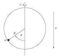
Eine Kugel der Masse m gleite reibungslos auf einem Ring mit Radius R unter dem Einfluß des homogenen Gravitationsfeldes. Der Ring soll mit einer konstanten Winkelgeschwindigkeit  $\omega$  um seine vertikale Achse rotieren. Dabei soll  $\theta$  die Position der Kugel auf dem Ring angeben (s. Skizze).
