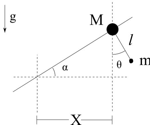
Eine Masse  $M$  gleite ohne Reibung auf einer geraden Schiene, die einen Winkel  $\alpha$  mit der Horizontalen einschließt. An der Masse hängt ein Pendel in Form einer masselosen Stange der Länge  $l$ , an deren Ende eine Masse  $m$  befestigt ist. Das Pendel könne nur in der Ebene schwingen, die durch die Vertikale und die Schiene aufgespannt ist. Beide Massen  $M$  und  $m$  unterliegen der Gravitationsbeschleunigung  $g$  in der vertikalen Richtung.
