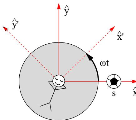
**Figure 1:** Sie liegen auf einem Spielplatz-Karussell, das sich mit einer konstanten Winkelgeschwindigkeit  $\omega$  dreht. Wir definieren ein mitbewegtes Koordinatensystem mit Einheitsvektoren  $\hat{x}', \hat{y}'$ , das also bezüglich des ruhenden Koordinatensystems  $\hat{x}, \hat{y}$  rotiert. Bezüglich  $\hat{x}, \hat{y}$  habe ein Ball die Koordinaten  $\mathbf{r}_0 = (x_0, y_0)^T = (s, 0)^T$ .
