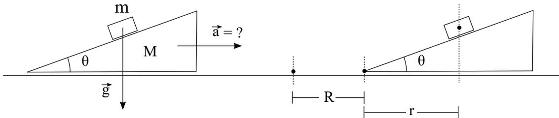
**Figure 1:** Ein Keil der Masse  $M$  könne reibungslos auf einer horizontalen Fläche gleiten. Auf dem Keil befinde sich ein Block der Masse  $m$ , der reibungslos auf dem Keil gleiten könne. Auf den Block wirkt die Gravitationskraft. Die Koordinate  $r$  sei der horizontale Abstand von der Kante des Keiles zum Schwerpunkt des Blockes und  $R$  sei der Abstand von der Kante des Keiles zu einem Referenzpunkt auf der Ebene.
