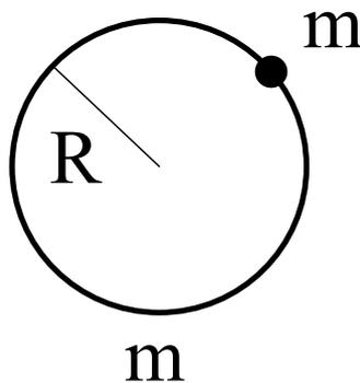
Betrachten Sie einen unendlich dünnen Ring der Masse  $m$  und Radius  $R$ . Auf dem Ring sei eine zusätzliche Punktmasse  $m$  angebracht (die gesamte Masse ist also  $2m$ ). Bestimmen Sie den Trägheitstensor im Hauptachsensystem mit Ursprung im Schwerpunkt des Rings.
