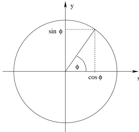
Abbildung II.1.7: Definition von Sinus und Cosinus am Einheitskreis.
