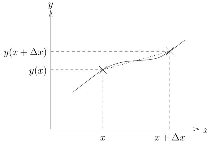
Abbildung II.2.1: Zur Definition der Ableitung
