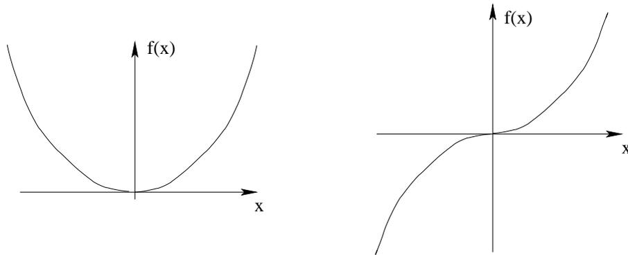
Abbildung II.1.4: Graph der Potenzfunktion  $f(x) = x^n$  für gerades  $n$  (links) und ungerades  $n$  (rechts).
