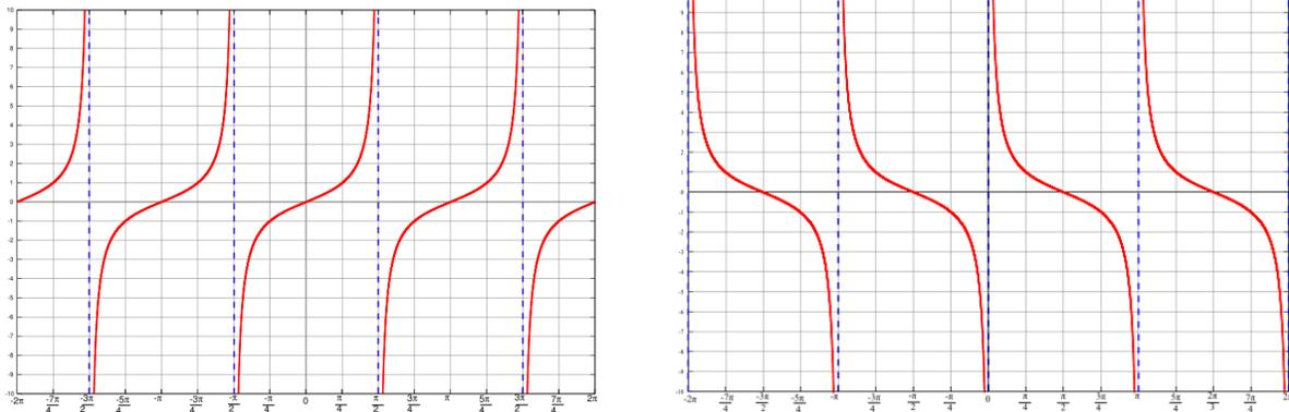
Abbildung II.1.9: Graph der Tangens- (links) und Cotangensfunktion (rechts).
