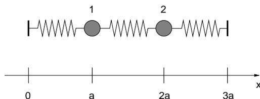
Betrachten Sie das in der Abbildung dargestellte eindimensionale System aus 2 Körpern (jeweils mit Masse  $m$ ), die über Federn (jeweils mit Federkonstante  $k$ ) untereinander und mit den Aufhängepunkten bei  $x = 0$  und  $x = 3a$  verbunden sind. Die Ruhelagen der Körper sind gegeben durch  $x_{n,0} = na$  ( $n = 1, 2$ ) und die Auslenkungen aus den Ruhelagen durch  $\xi_n = x_n - x_{n,0}$ .
