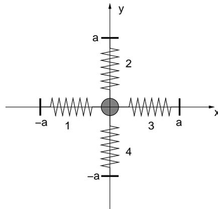
Betrachten Sie das in der Abbildung dargestellte zweidimensionale System aus einem Teilchen der Masse  $m$  und vier Federn jeweils mit Federkonstante  $k$ . Die Aufhängepunkte der Federn sind gegeben durch  $\vec{a}_i = (\pm a, 0)$  und  $(0, \pm a)$  ( $i = 1, \dots, 4$ ), der Ort des Teilchens ist  $\vec{r} = (x, y)$ , mit  $\vec{r} = (0, 0)$  einer Ruhelage des Systems. Die Beiträge der einzelnen Federn zur potentiellen Energie sind
