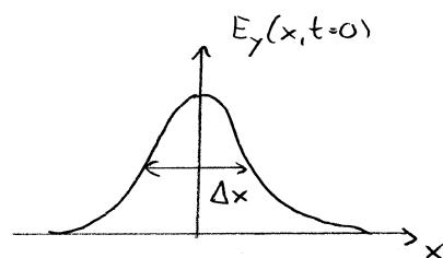
$$\Rightarrow E_o(k) = \frac{1}{2\pi} \int_{-\infty}^{\infty} a e^{-\frac{1}{2} \left(\frac{x}{\Delta x}\right)^2} e^{-ikx} dx \\ = a \sqrt{\frac{1}{2\pi}} \Delta x e^{-\frac{1}{2} (k \Delta x)^2} \rightarrow \text{ebenfalls eine Gaußverteilung, Breite } \frac{1}{\Delta x}$$
