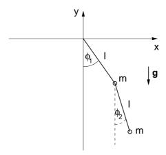
Gegeben sei ein ebenes Doppelpendel mit den Massen  $m_1 = m_2 = m$  und den Pendellängen  $l_1 = l_2 = l$ . Die Auslenkungswinkel sind (wie in der Abbildung dargestellt) durch  $\phi_1$  und  $\phi_2$  gegeben. Die Schwerkraft wirkt in negativer y-Richtung.
