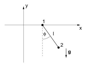
Das in der Abbildung dargestellte System besteht aus zwei Körpern (Massen  $m_1$  und  $m_2$ ), die über einen masselosen Stab der Länge l verbunden sind. Die Bewegung von Körper 1 ist auf die x-Achse eingeschränkt.
