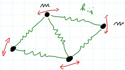
$x_i(t)$ : Auslenkung aus stabile Gleichgewichtslage zum Zeit  $t$
