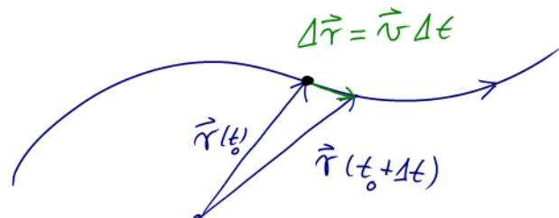
momentane Geschwindigkeit  $\vec{v}(t_0)$  erlaubt lineare Näherung der Bahn  $\vec{r}(t)$  bei  $t \approx t_0$ :
