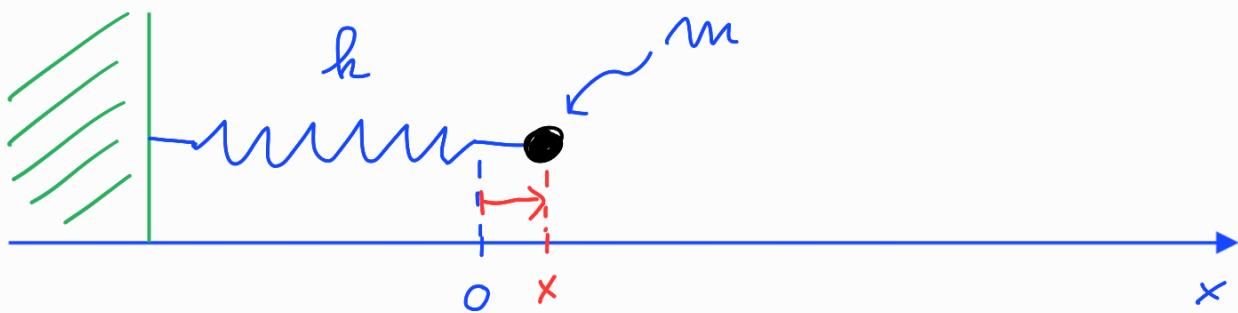
Fedekraft:  $\underline{F(x)} = -h x$  : Federkonstante  $\underline{=}$
