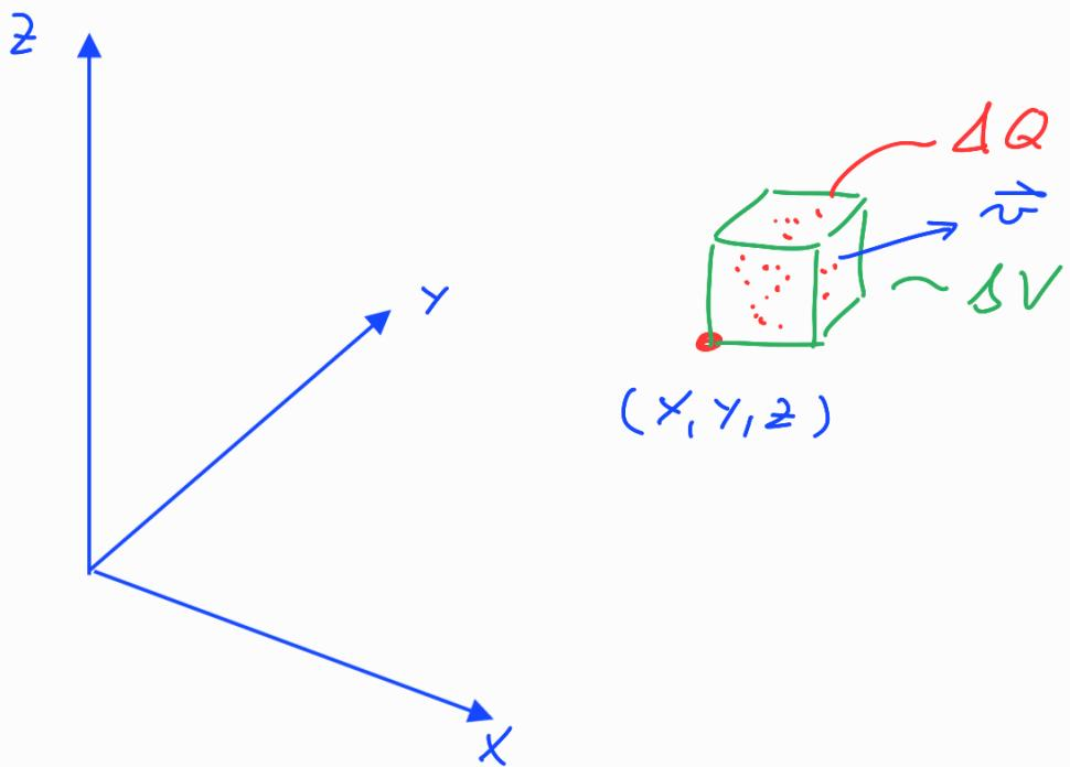
Ladungsdichte:  $s(x, y, z, t) = \frac{\Delta Q}{\Delta V}$
