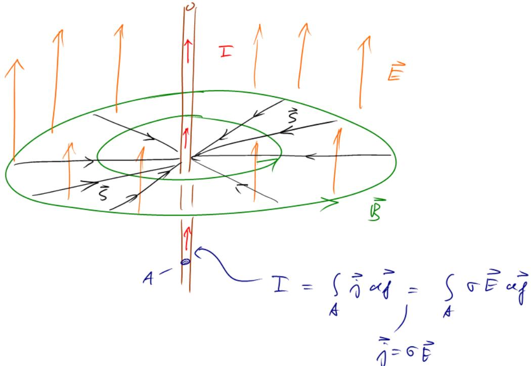
Die radial einströmende Energie hält den elektr. Strom gegen den elektr. Widerstand des Leiters aufrecht.
