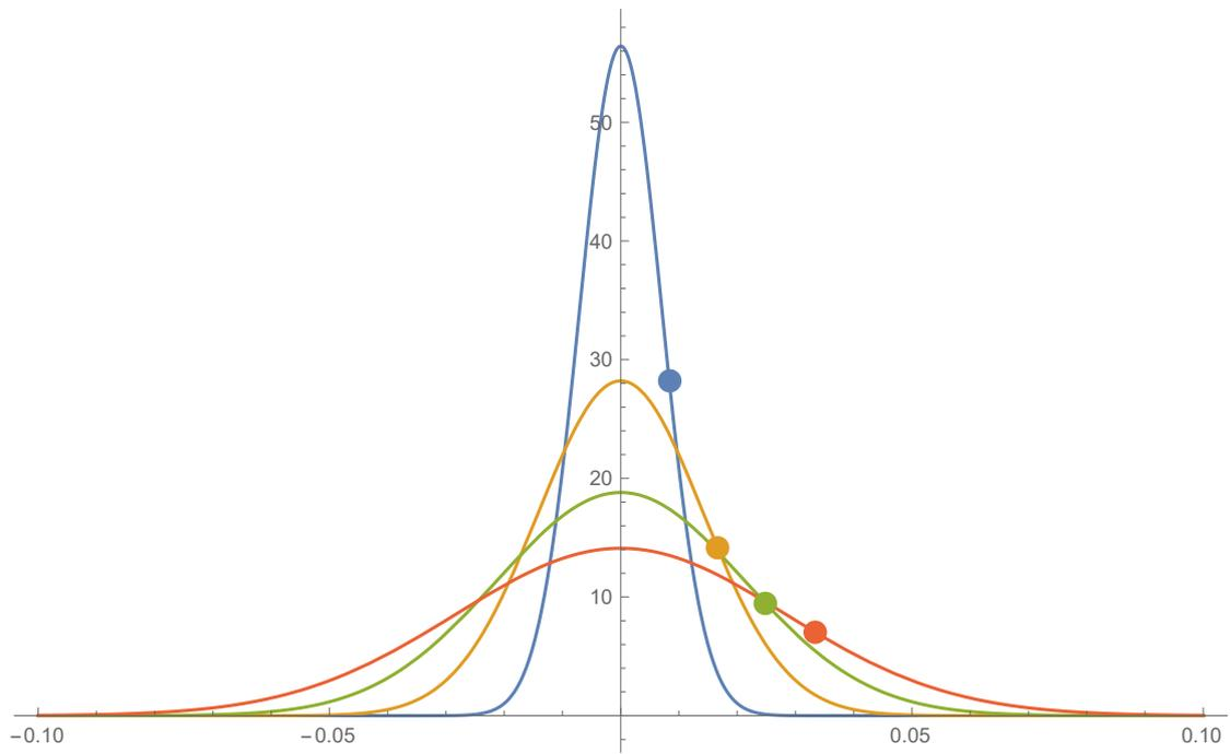
Abbildung 1: Ausbreitung des Temperaturprofils. Die Zeit wächst von einer Funktion zur nächsten quadratisch, d.h. die Punkte die die Halbwertsbreite markieren, haben gleichen Abstand auf der x-Achse zueinander.
